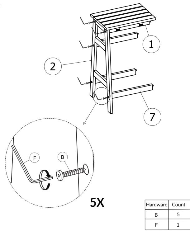
TIGHTEN SCREW COMPLETELY.
